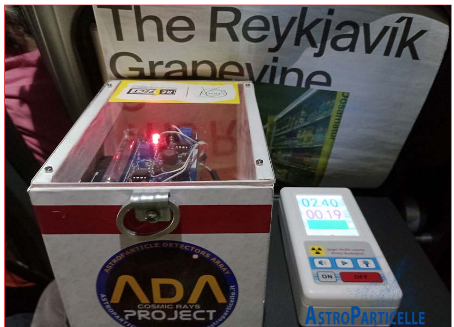
Misure di raggi cosmici e radiazione ionizzante totale in volo.
