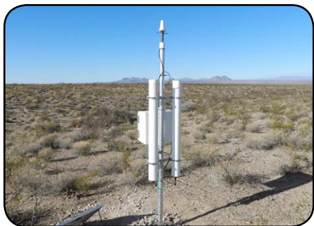
Un sensore per neutroni cosmici che è servito per determinare la quantità di umidità nel bacino idrico del deserto di Chihuahuan - New Mexico.
