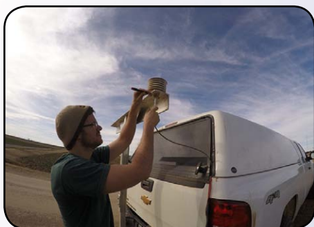
Installazione di un rivelatore di neutroni cosmici.
