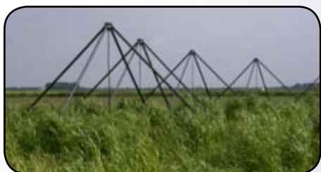
Array di antenne LOFAR (cortesia LOFAR).
