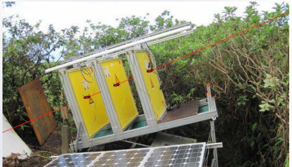
Un tipico telescopio per muoni (odoscopio) che fa uso di tre pannelli a scintillazione a matrice (cortesia Jacques Marteau).
