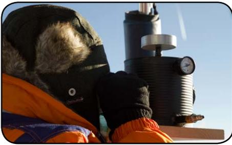
Misure in corso con l'elettroscopio, riproduzione della "camera" 3 di V. Hess. Attraverso lo strumento dietro agli indicatori di carica si vedono le alpi al rovescio.
