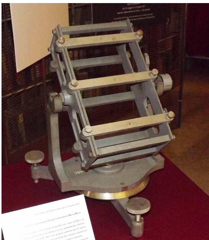
Figura 5 - Il telescopio per raggi cosmici di Bruno Rossi conservato all'Università di Padova (immagine dell'autore).
