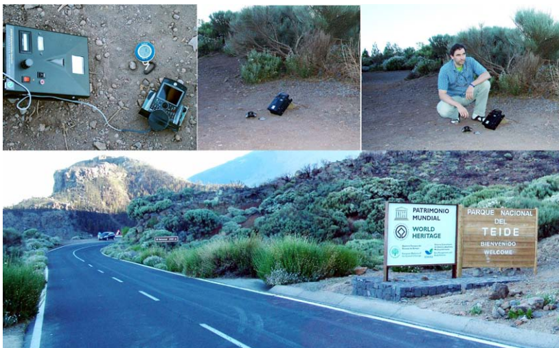
Figura 13 - Misure Est-Ovest al parco del Teide (Canarie) con il rivelatore AMD4.
