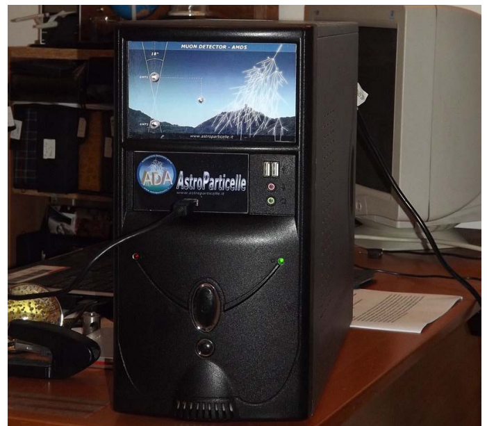
Figura 2 - Uno dei rivelatori di raggi cosmici AMD5. Essi sono costruiti in un case per p.c. e collegati a personal computer.
